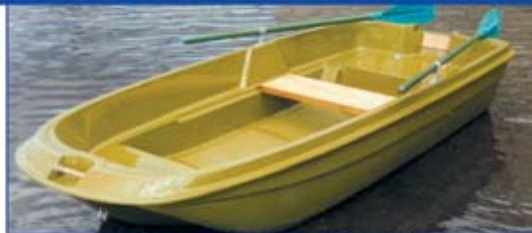
Автомобильная лодка (картол). Длина 2.65 м, ширина 1.10 м. Вместимость 3 чел. Рекомендуемая мощность мотора до 3 л.с. Стандартная комплектация: весла, банка.
