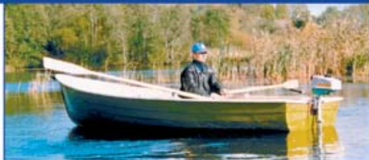
Гребная однопарная лодка. Длина 4.15 м. Ширина 1.55 м. Вместимость 4 чел. Рекомендуемая мощность мотора до 8 л.с. Стандартная комплектация: весла.
