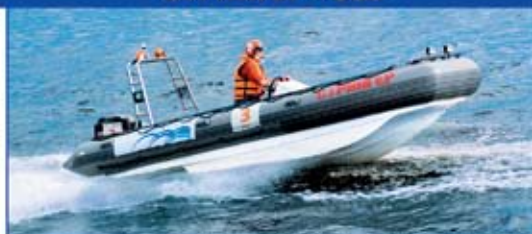
Моторная лодка с надувным бортом (RIB). Длина 5.50 м. Ширина 2.20 м. Вместимость 8 чел. Рекомендуемая мощность мотора от 40 до 150 л.с. Стандартная комплектация: рулевое управление, мачта, комплект диванов, электрооборудование, весло.
