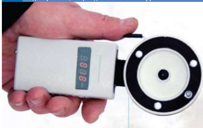
Глубиномер позволяет точно измерить глубину водоема с изображением результатов измерения в виде числа на светодиодном индикаторе.
